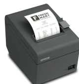
POS-D TP 300 PRO Velocidad de impresión 260mm x seg con salida frontal 3 puertos incluidos usb, serial y ethernet Carcasa de plástico resistente Impresión de código de barras 1D y 2D Emulación ESC/POS
